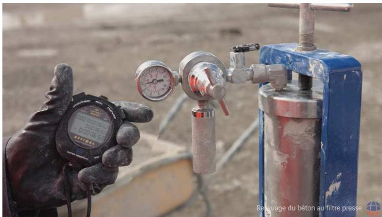
Ressuage du béton au filtre presse
